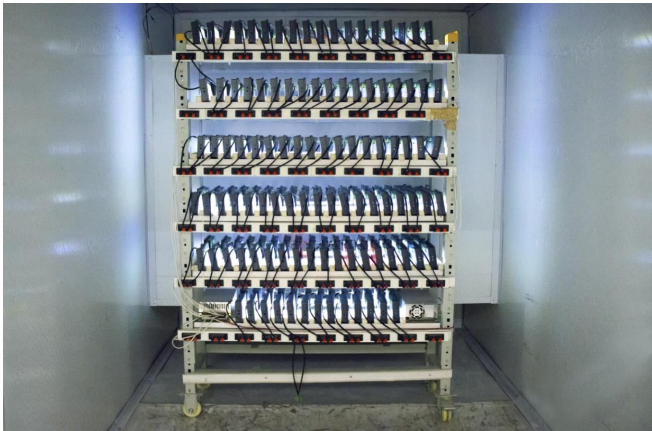
测试环境:高低温老化测试箱中
